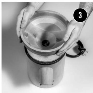
Nehmen Sie nun den Trichter und drehen ihn im Uhrzeigersinn eine Umdrehung zu. Dann stecken Sie den Netzstecker ein, schalten das Gerät an und drehen den Trichter weiter zu bis ein leichter Steinkontakt hörbar ist.
